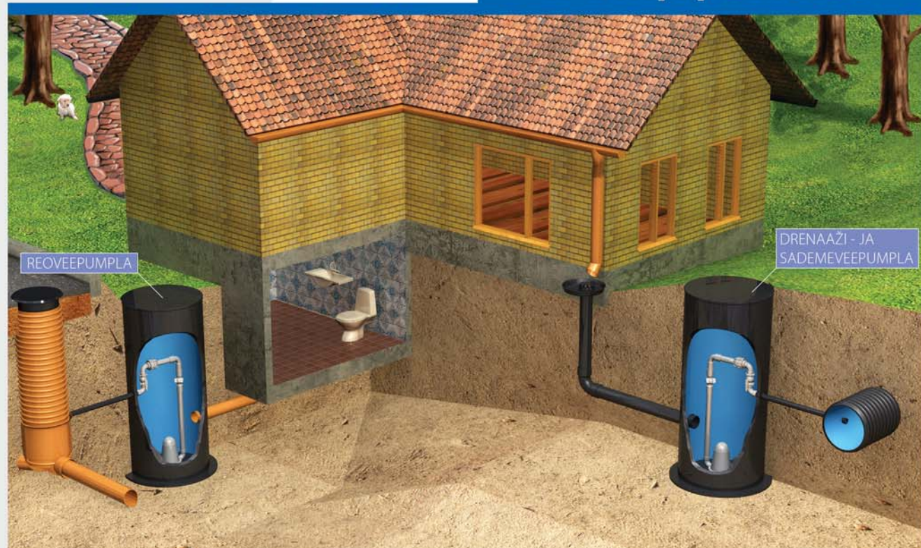
Joonis 1. Eramaja reovee- (vasakul) ning sademe- ja drenaaživeepumpla
