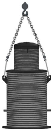
Joonis 3. Kaevu tõstmine
