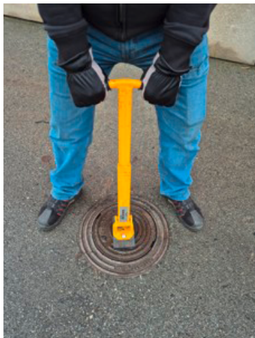
Joonis 14. Tõstmine kaevuluugi magnetiga
