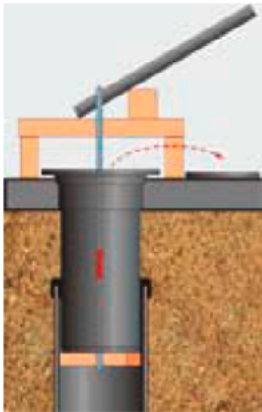
Joonis 6. Kaevuteleskoobi tõstmine
